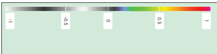
Рисунок 2- Шкала индексов для NDVI (от -1 до 0 не одушевленные/мертвые материалы (дороги, здания, почва, мертвые растения), от 0 до 0,35 нездоровое растение, от 0,35 до 0,65 растение с хорошими жизненными показателями, от 0,65 до 1 полностью здоровое растение).
